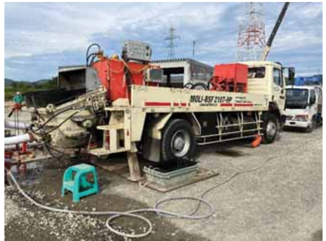
写真-3 コンクリートポンプ車 (BSF2107HP)
