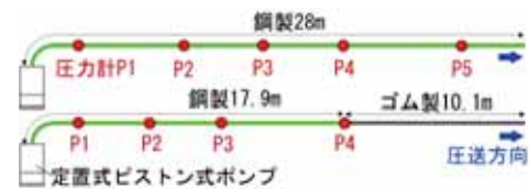
図-4 既往②の配管の概要(平面図, 圧送距離28mの例)
