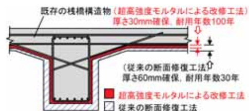
図-1 塩害により下面が劣化した海上棧橋の改修概要
