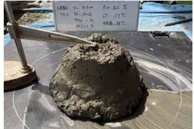
写真-5 圧送後試料試験状況 (スランプ : 16.0cm)
