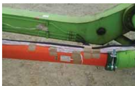
写真-1 ブームに設置したひずみゲージ
