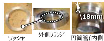
写真-3 回転治具の改良品
