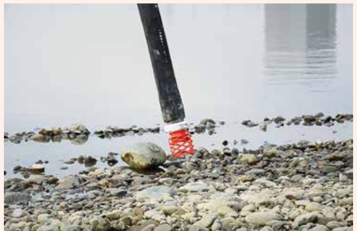
障害物に水の吸入が阻まれることを防止するための器具
