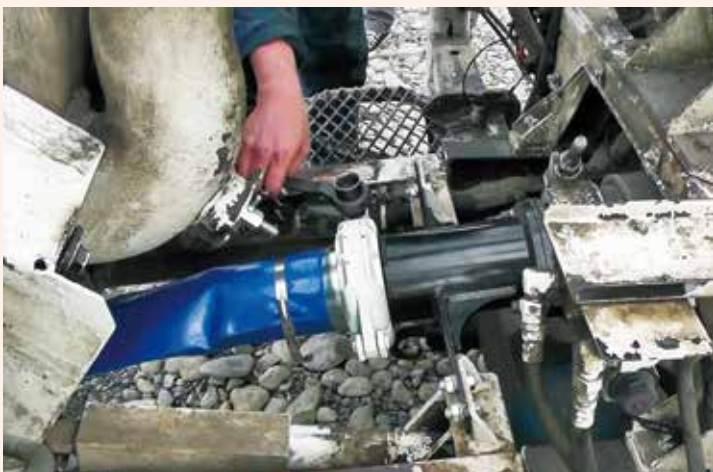
吸入した水を任意の場所に排出する専用のホースを取り付ける専用のアタッチメント
