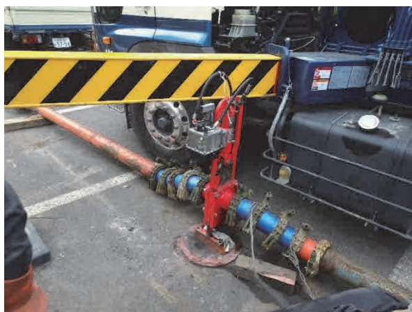
写真-2 油圧ストッパー(前後に手動式ストッパー)
