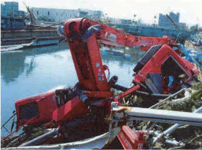
写真-4 仙台市内にて津波で大破したポンプ車
