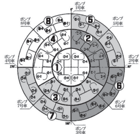
図-1 分岐管工法による配管計画図
