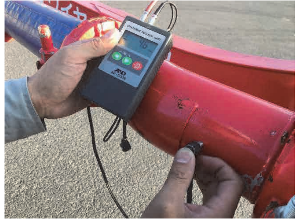
写真-2 超音波肉厚検査
